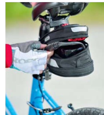
Der 180-Wattstunden-Akku ist unauffällig in der Satteltasche untergebracht.
