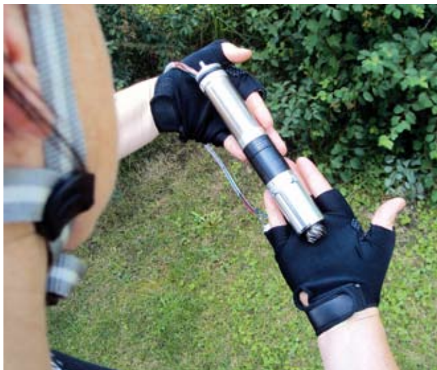
Links: Probefahrt auf einem kaum sichtbaren Wirtschaftsweg. Oben: der kleine Vivax assist-Sattelrohrmotor. Am unteren Ende: Kegelkopf für den Antrieb der Tretlagerachse.
