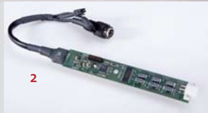
Bild 1: Der Akkupack wiegt nur 850 Gramm. Bild 2: Die intelligente Regelungstechnik ermöglicht eine Kommunikation zwischen Fahrer und Antrieb. Bild 3: Die schmale Hightech-Getriebe-Einheit passt ins Sitzrohr.
