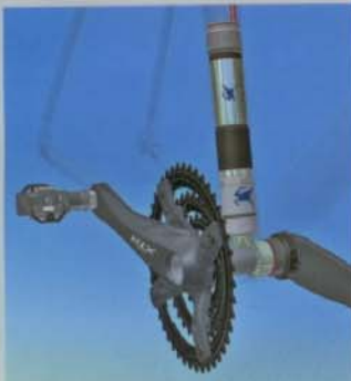
Unsichtbar: Der Motor steckt passgenau im Sitzrohr. Über ein Kegelgetriebe treibt er die Tretlagerwelle direkt an.
