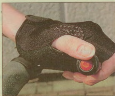
Der Antrieb wird unsichtbar ins Sitzrohr eingebaut (Bild oben). Er wird über ein Getriebe mit dem Tretlager verbunden. Der Schalter wird am Lenker montiert.
