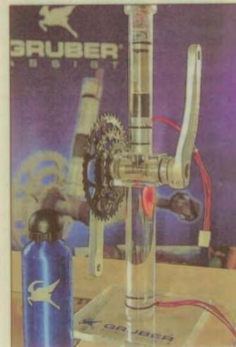
Der Antrieb wird unsichtbar ins Sitzrohr eingebaut (Bild oben). Er wird über ein Getriebe mit dem Tretlager verbunden. Der Schalter wird am Lenker montiert.
