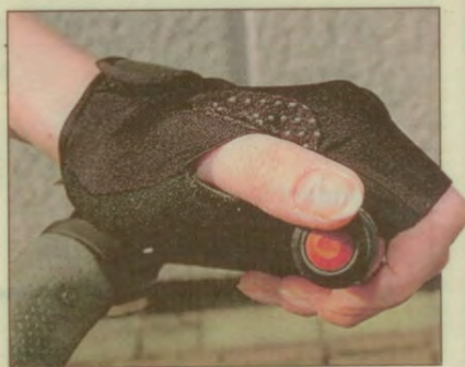
Der Antrieb wird unsichtbar ins Sitzrohr eingebaut (Bild oben). Er wird über ein Getriebe mit dem Tretlager verbunden. Der Schalter wird am Lenker montiert.
